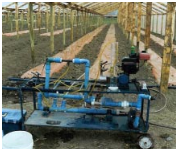
Foto 3. Equipo de aplicación de Metam Sodio mediante riego por cinta.
