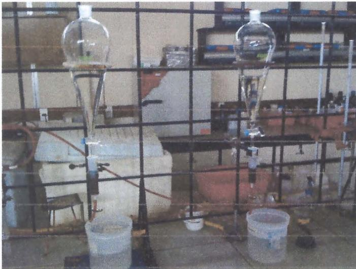
Figura 2: Set up experimental para evaluar la velocidad máxima de flujo del agua a través de la resina específica para Arsénico.
