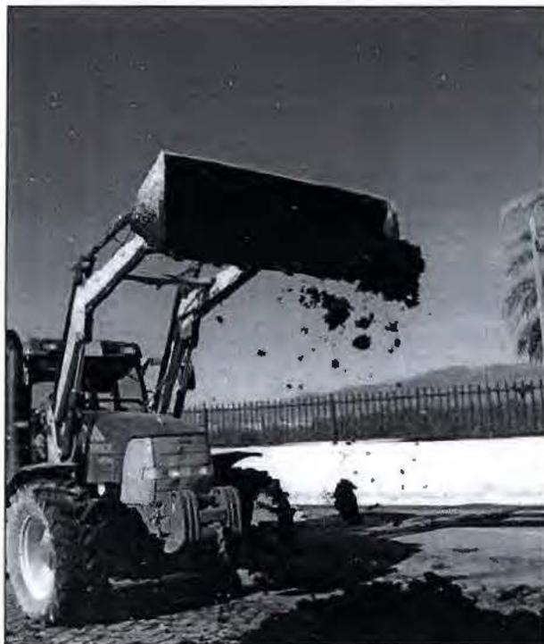
Figura 5: Volteo de pilas de alperujo utilizando tractor con pala mecánica
