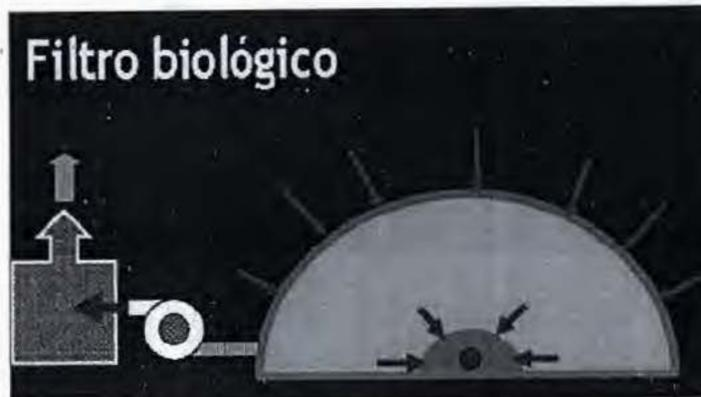
Figura 5: Esquema de operación de una pila ventilada por el sistema Beltsville
