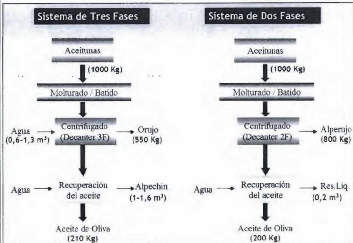
Figura 4: Proceso de obtención de aceite de oliva a través de sistemas de centrifugación de tres y dos fases.
