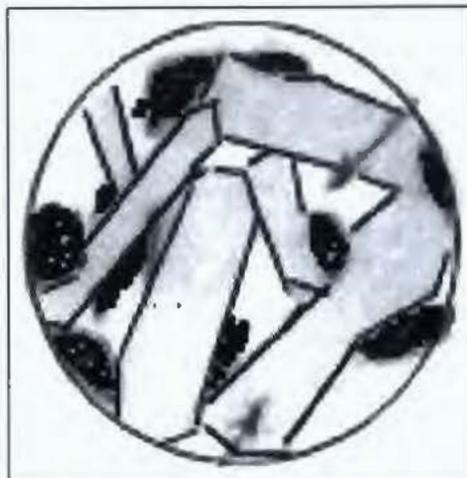
Figura 8: Esquema de la función del material estructurante en mezcla con Alperujo
