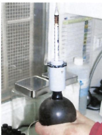
**Imagen 3.** Bomba Drugger con tubo Drugger colorimétrico.
