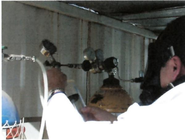
**Imagen 4.** Proceso de extracción de fosfina desde cilindro presurizado.
