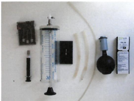
**Imagen 1.** Implementos para la fumigación con fosfina. De Izquierda a derecha: Geringas cromatográfica, mangueras de conexión entre cámara y geringas, bomba Drugger y tubos colorimétricos Drugger para medición de fosfina.
