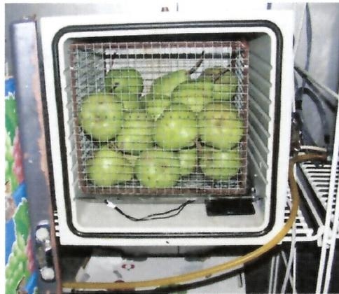
**Imagen 5.** Cámara de 28,3 L con peras en proceso de fumigación.
