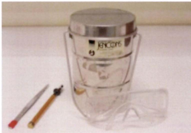
**Imagen 7:** Materiales utilizados en proceso de congelación/descongelación, de izquierda a derecha: Pinza, Lápiz diamante, contenedor de transporte y gafas protectoras.
