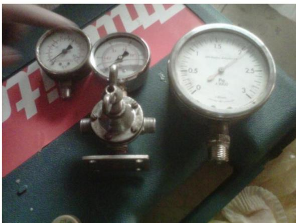
Cambio de manómetro (medidor de presión) de la torre de secado
