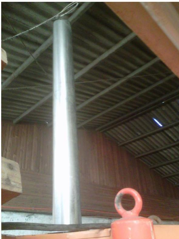
Chimenea de la torre. Por donde se evapora el contenido de humedad que poseen las muestras
