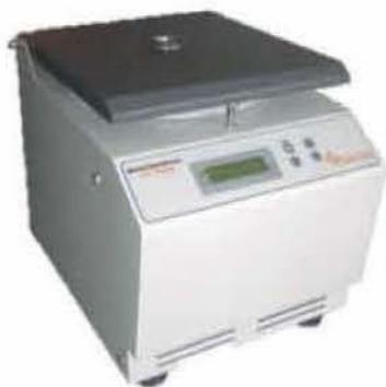
8. Tapar la centrifuga y ponerla en funcionamiento hasta que alcance 1.200 R.P.M El tiempo de centrifugado para separar la grasa del resto de los componentes, es de 15 minutos.
