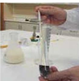
4. Introducir el Lactodensímetro suavemente en la leche, para después ponerlo en rotación de manera que gire sobre su eje.
