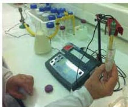
6. Continuar la calibración, sumergiendo el electrodo en la solución de calibración pH 7,01. Esperar hasta que en el visor se indique que se alcanzó el pH 7,01.
