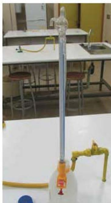
5. Efectuar la lectura en la columna graduada de la bureta. El gasto en ml de hidróxido de sodio, corresponde a los grados de acidez expresados en grados Thorner ( $^{\circ}\text{Th}$ ). Ej. 18 ml equivalen a 18 $^{\circ}\text{Th}$ .
