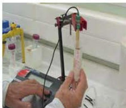
4. Calibrar el pH-metro, habilitando la función correspondiente y sumergiendo el electrodo en la solución de calibración pH 4,01. Esperar hasta que en el visor se indique que se alcanzó el pH 4,01.
