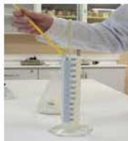
2. Ajustar la temperatura a la indicada en el lactodensímetro, usando un baño de agua fría.
