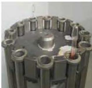
9. Finalizada la centrifugación, esperar a que la centrifuga se detenga antes destaparla y retirar el butirómetro.
