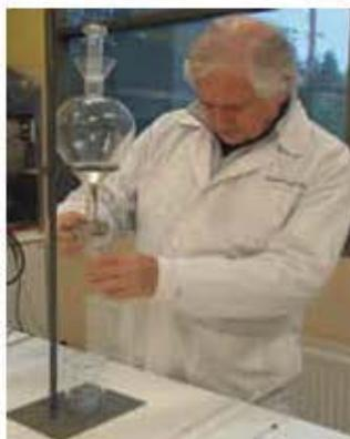
2. Descargar 10 ml de ácido sulfúrico en el butirómetro.
