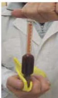
6. Envolver en un paño húmedo el butirómetro y a continuación agitarlo con objeto de que la muestra y los reactivos se mezclen bien. Al hacerlo se produce una reacción que desprende mucho calor y por ello, es que el analista debe protegerse con el paño.
