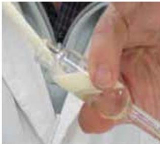
3. Medir con la pipeta graduada 10,75 ml de la muestra y descargarlos lentamente sobre la pared del Butirómetro. Una descarga rápida, provocará que se produzca una reacción que quemará parte de la muestra. Esto debe evitarse.
