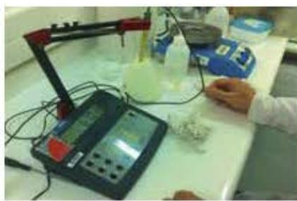
8. Medir el pH sumergiendo el electrodo en la muestra y registrar el valor de pH indicado en el visor.
