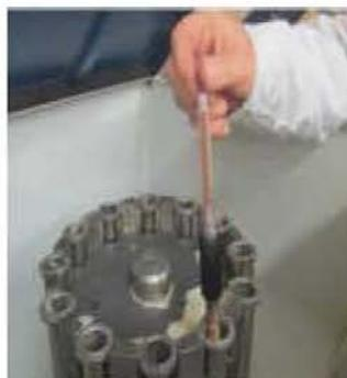
7. Poner el butirómetro en uno de los capachos de la centrifuga, colocando otro con agua en el capacho opuesto, con el fin de equilibrarla.
