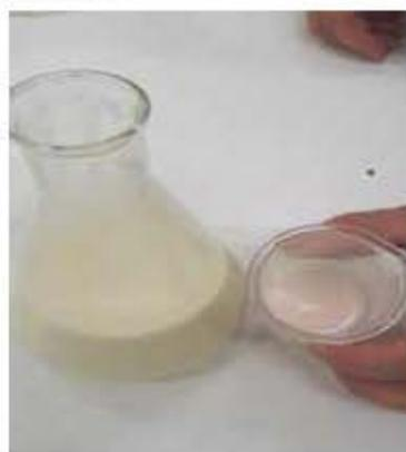
4. Iniciar la valoración de la acidez descargando gota a gota el Hidróxido de Sodio, mezclando al mismo tiempo, con movimiento de rotación, hasta alcanzar un color rosado pálido que permanece estable.
