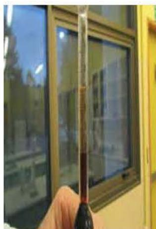
11. Retirar el butirómetro del B.M. usando el paño húmedo y proceder a efectuar la lectura. Si la materia grasa no se encuentra en su totalidad en la columna graduada del butirómetro, presionar el tapón introduciéndolo hasta que esto ocurra.
