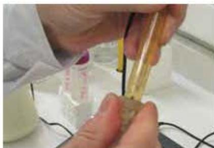
11. Colocar en el extremo del electrodo la cápsula protectora que contiene la solución de KCl.
