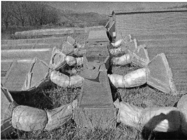
**Figura 10. Sistema colector del aire caliente que va ser introducido a las cámaras de secado**
