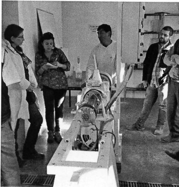
Figura 18. Extrusora Artesanal construida usando una caja de cambio de FORD T
