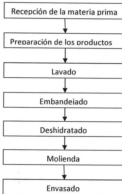
**Figura 12. Línea de proceso de productos deshidratados**
