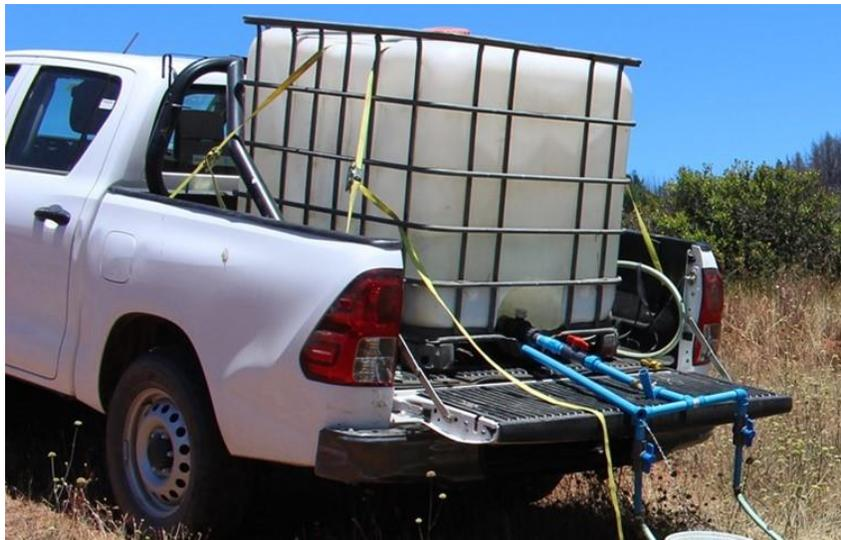
**Figura 7.** Sistema de riego por gravedad.
