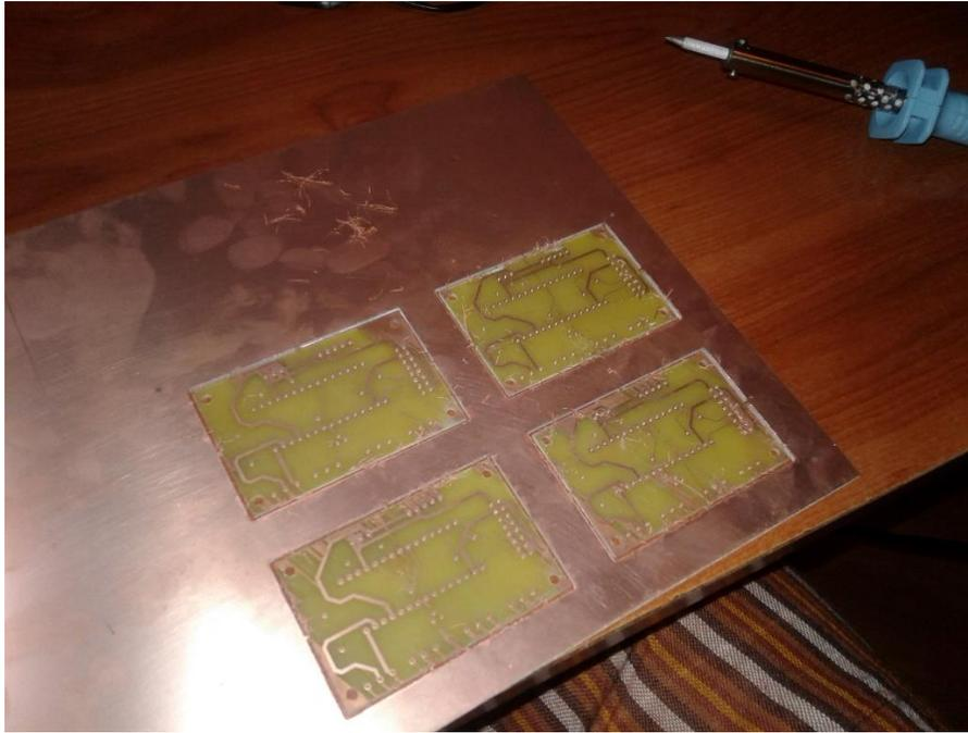
*APISMART 2.0 – Prototipo electrónico – Placa electrónica fabricada de forma artesanal exclusiva para el funcionamiento requerido.*
