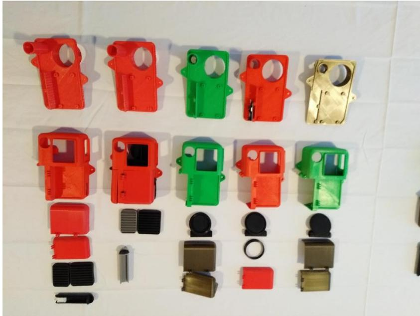
*APISMART 4.0 – Prototipo físico - Módulo funcional de temperatura y humedad, producción serie corta, previo a ser armado.*
