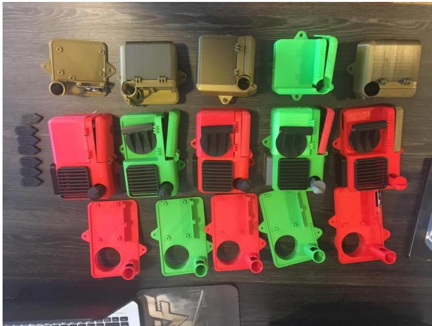
*APISMART 4.0 – Prototipo físico - Módulo funcional y módulo de testeo de temperatura y humedad, producción serie corta, en etapa de armado y comprobación de calces.*
