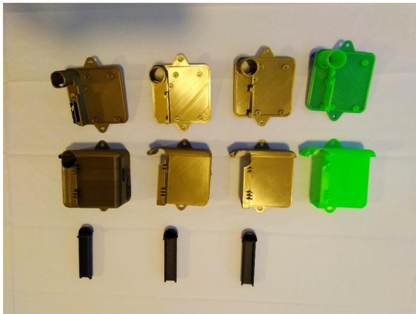
*APISMART 4.0 – Prototipo físico - Módulo de testeo de temperatura y humedad, producción serie corta, previo a ser armado.*
