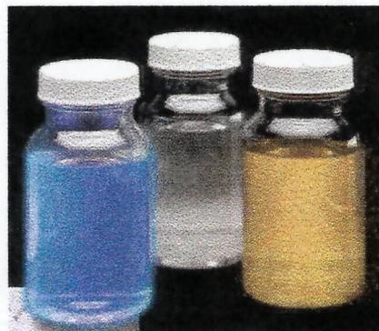
**Simplate test de Ideex d Método desarrollado para determinar coliformes totales y *Escherichia coli* en muestras de alimentos.**
