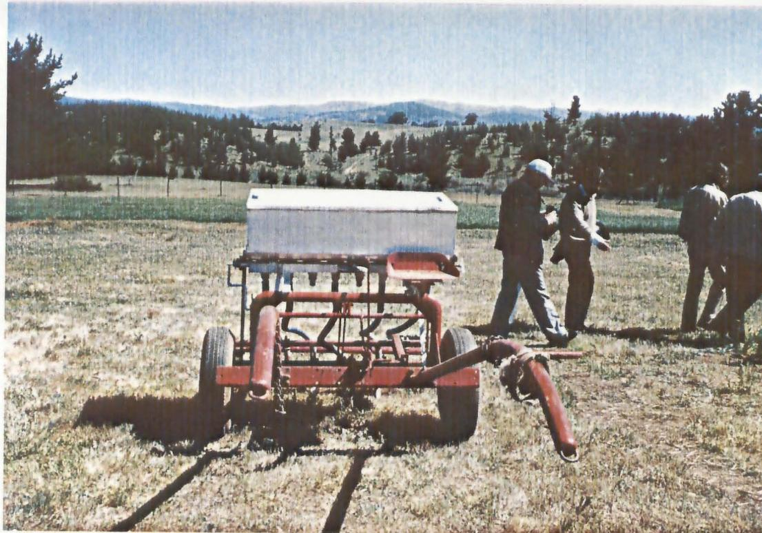
FOTO 1. Vista frontal sembradora de tracción animal para siembra directa
