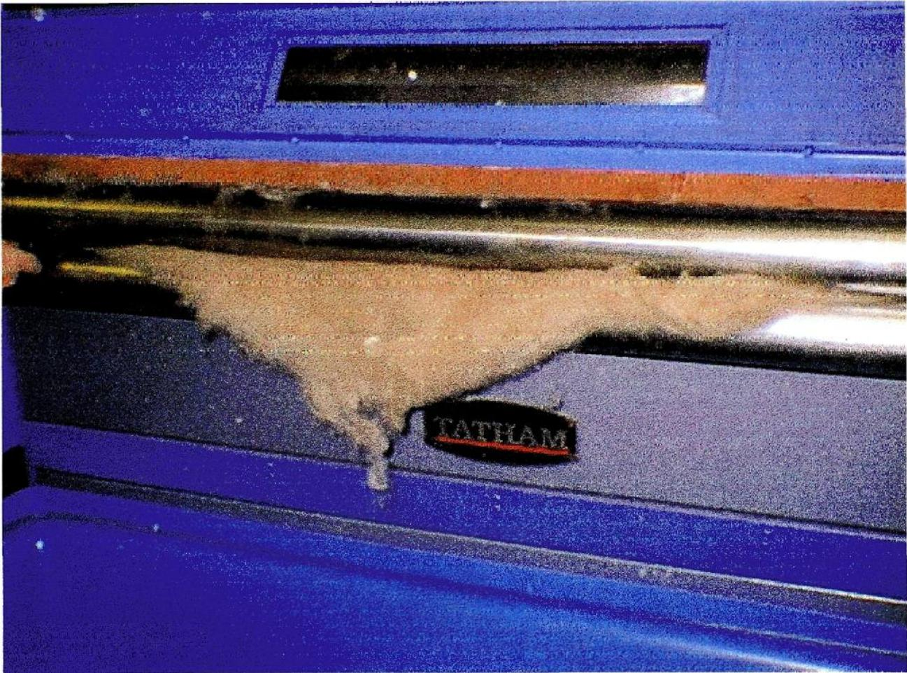
Foto 12. Máquina descordadora de 3 secciones modelo DH3 1500 en Tatham's Mill procesando fibra de guanaco. Inglaterra, Gran Bretaña (Foto: Fernando González).
