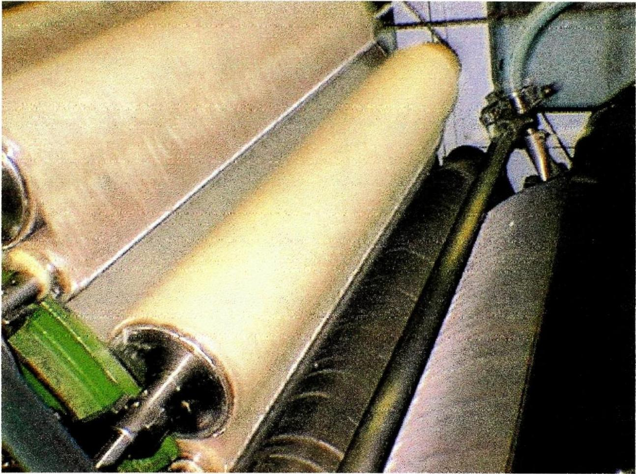
Foto 14. Máquina cardadora en funcionamiento con fibra de cachemira en Johnston's de Elgin, Escocia, Gran Bretaña (Foto: Fernando González).
