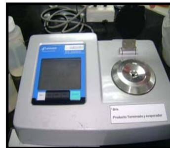
**Figura 4.** Vista de equipo refractómetro ATAGO RX – 5000  $\alpha$
