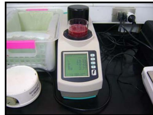
**Figura 3.** Vista de equipo Fotocolorímetro Hunter Lab Color Flex CX 1225 en empresa Agrozzi
