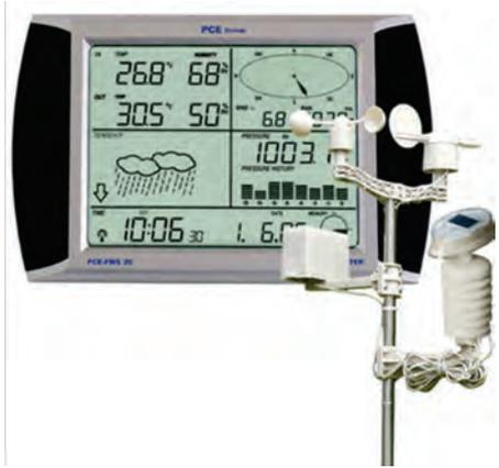
**Figura 2.9.** Micro estación meteorológica adosada al neblinómetro, que permite caracterizar las condiciones micrometeorológicas del lugar en forma constante.
