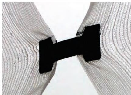
**Figura 2.28.** Broches de unión entre mallas del atrapanieblas.
