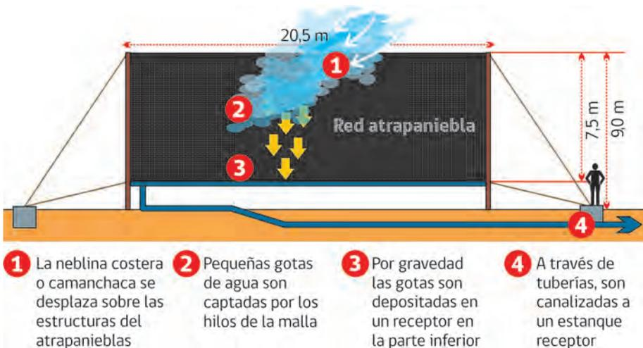
**Figura 2.3.** Esquema de "Atrapanieblas bidimensional" y sus componentes principales.
