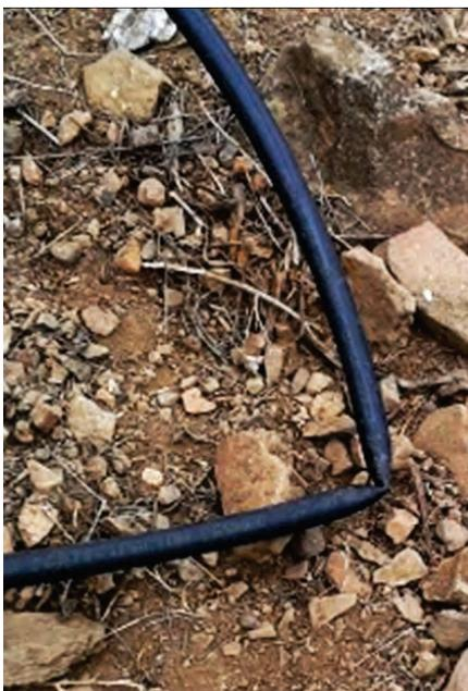
**Figura 2.40.** Ducto conductor de agua con estrangulaciones.
