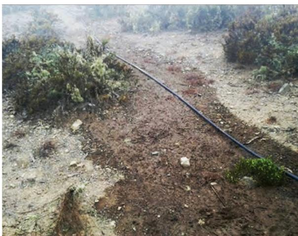
**Figura 2.41.** Rotura de ducto de conducción de agua desde atrapanieblas hacia estanques de acumulación. Aparición de vegetación junto a roturas.
