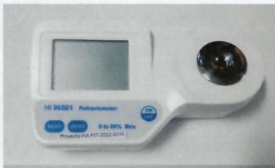
**Equipo N°3:** Refractómetro (Medidor de Sacarosa)
