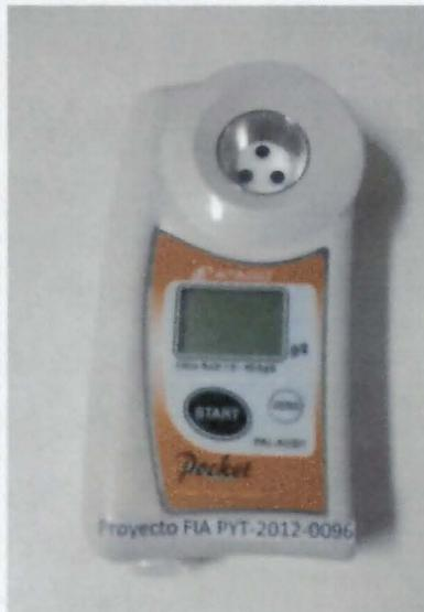
**Equipo N°1:** Medidor de Ácido Cítrico
