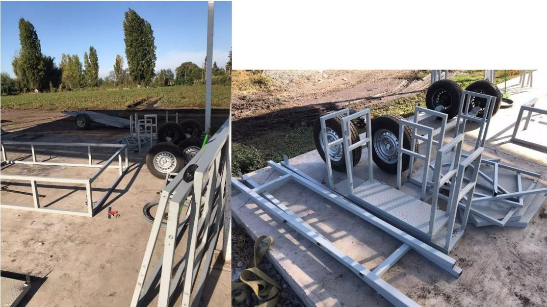
Durante el desarmado de los carros se notaron dos soldaduras forzadas, una en las barandas de los techos y otra en el chasis.
