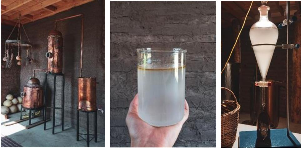
Alambique de 40 litros de materia prima para la destilación específica de Plantas para la obtención de aceites esenciales e hidrolatos.
