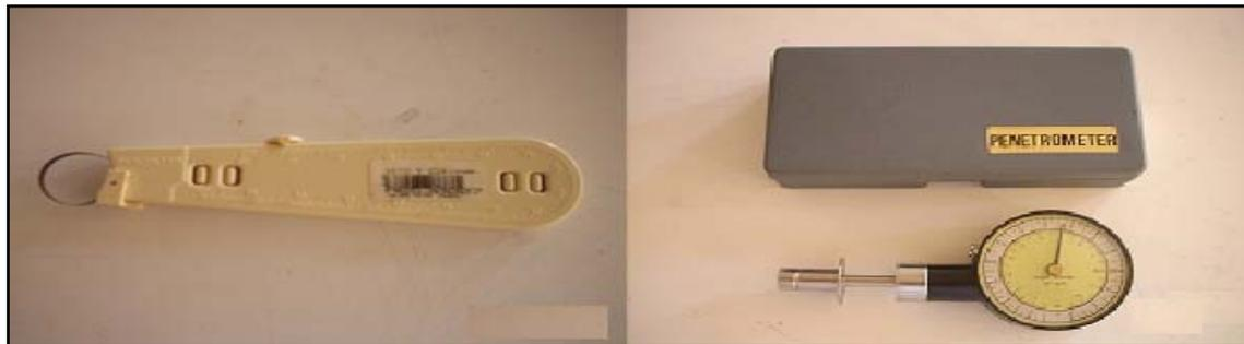
**Figura 4.** Huincha expandible y penetrómetro (figura de la izquierda y derecha, respectivamente).
