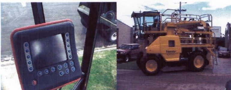
Figura 10. Equipo cosechador y panel de control de monitoreo de rendimiento.
