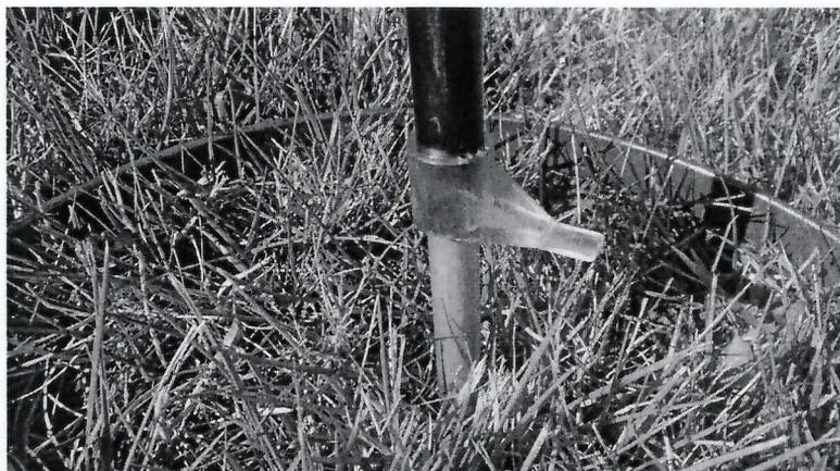
*Medición de la altura sin disturbar en una pradera. La lengüeta se baja hasta que toque la primera hoja.*
