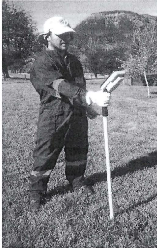
Foto 12: Equipo de medición de praderas mediante capacitancia eléctrica.
