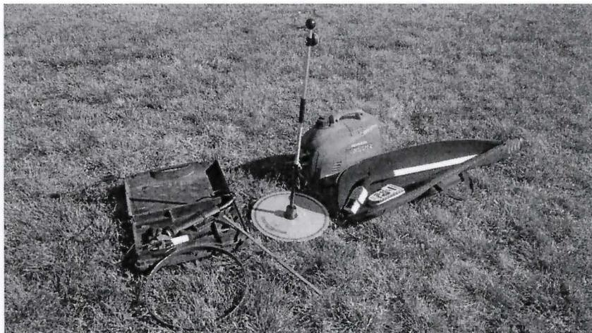
*Equipo de muestreo: tijeras eléctricas, grupo electrógeno, marco de muestreo, instrumentos de medición (plato y capacitómetro).*
