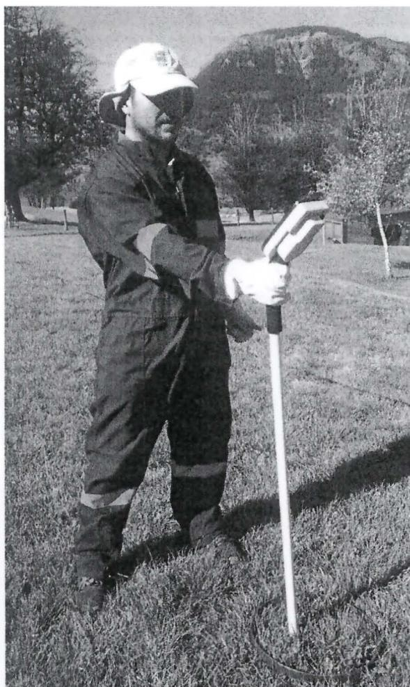
Figura 1. Uso del capacitómetro para medir la disponibilidad de forraje.
