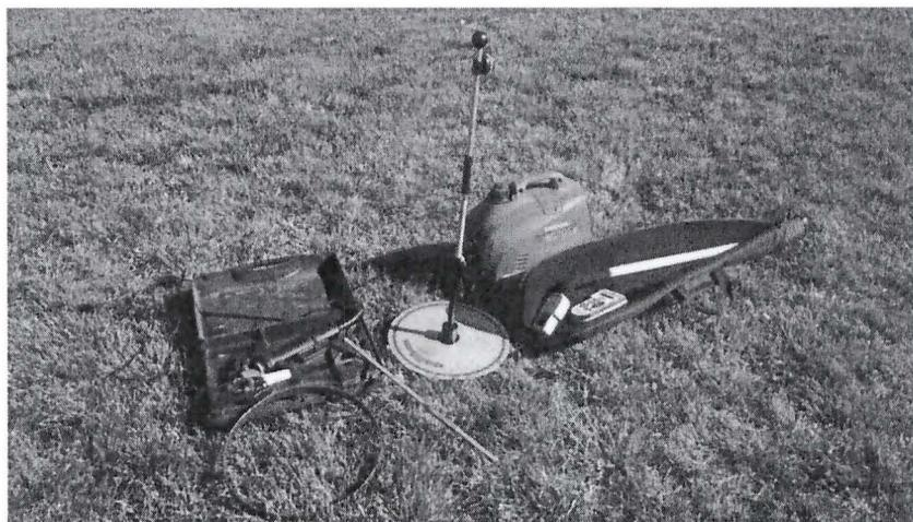
Foto 8. Equipo de muestreo: tijeras eléctricas, grupo electrógeno, marco de muestreo, instrumentos de medición (plato y capacitómetro).
