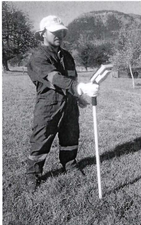
*Equipo de medición de praderas mediante capacitancia eléctrica.*
