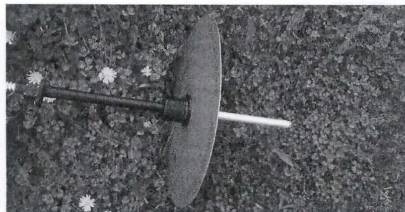
Figura 1. Vista lateral del plato. Se observa el vástago central y a la derecha el extremo que toma contacto con el suelo.
