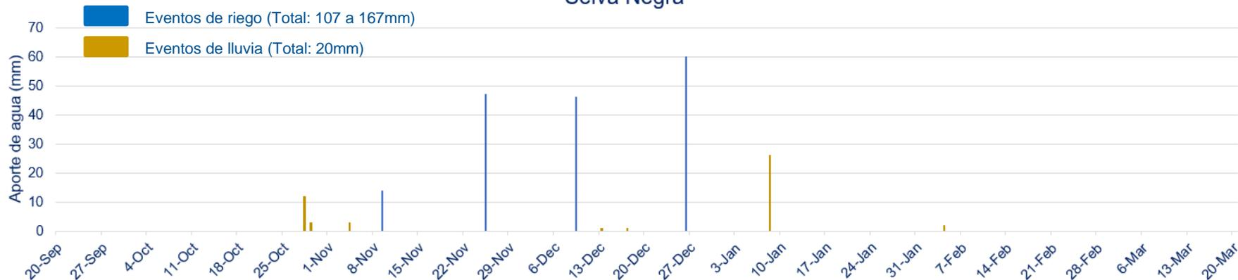
Riegos determinados en base sensores de humedad de suelo.
