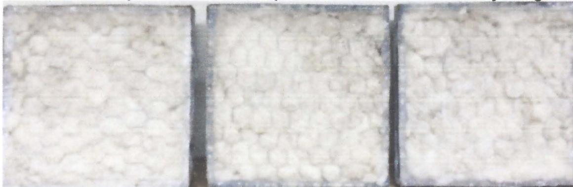
Foto: Lanarq, Ensayo de permeabilidad del Vapor, laboratorio IDIEM
