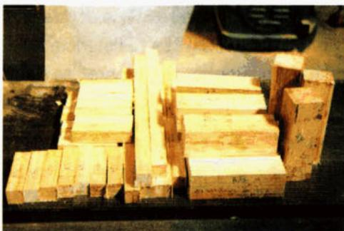
Probetas de ensayo para resistencia mecánica
