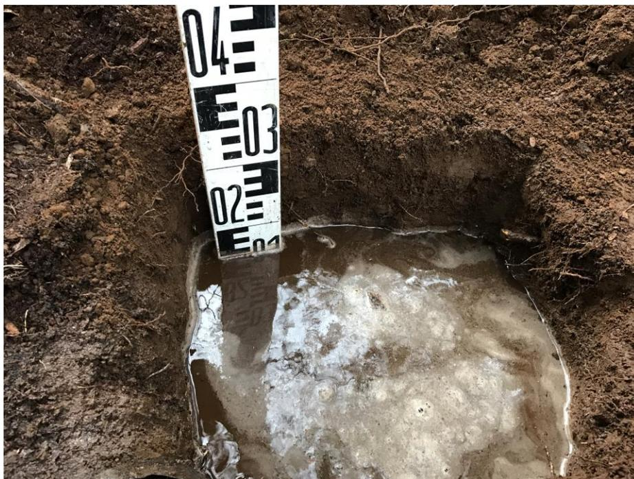
**Figura 2.2. Infiltración de agua, nivel 12.5 cm**
