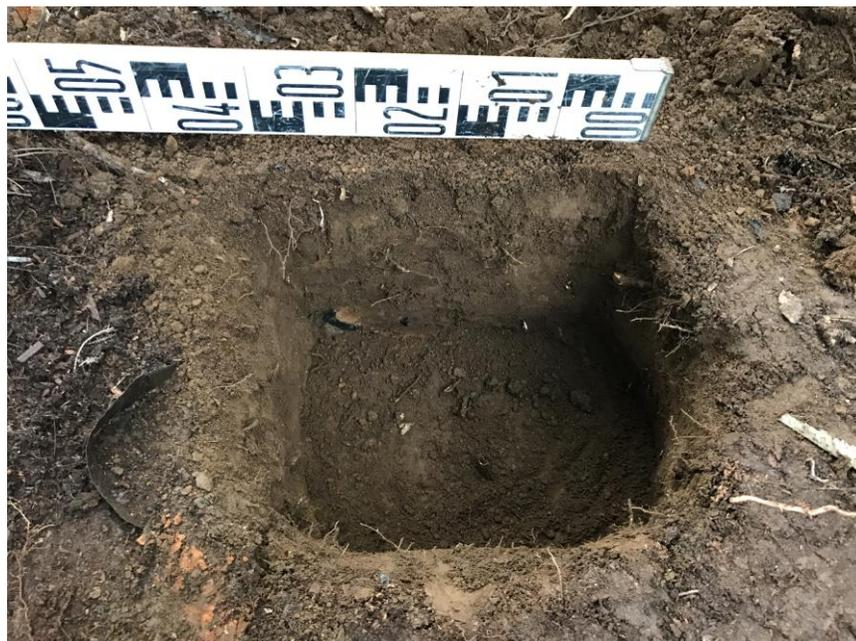
**Figura 2.5. Excavación en Terreno, Hoyo aristas 30 cm, Imagen 2**
