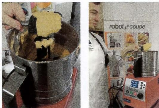
Figura 1.5: Equipo homogenizador para mezclas de vegetales en la producción de paté.
