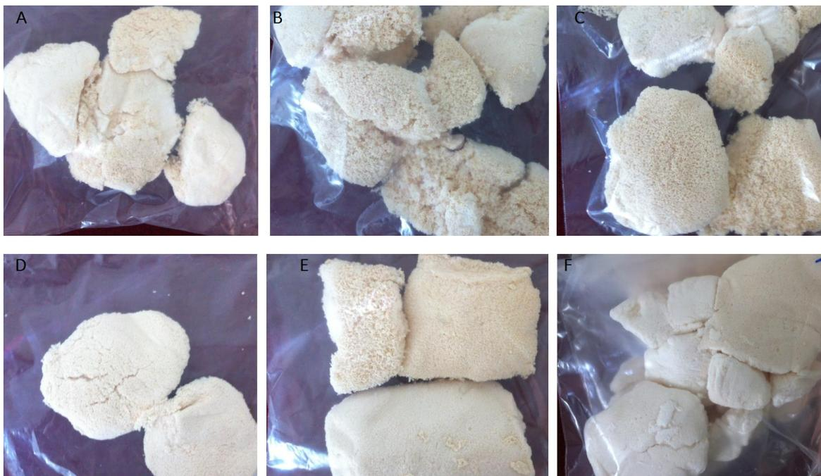
*Figura 8.13. Material espumado obtenido en medio acuoso y liofilización con 28% polvo de lija, 42% almidón 5% PVA, 5% anhídrido maleico (en % seco). La arcilla se agregó al 3% adicional.*
