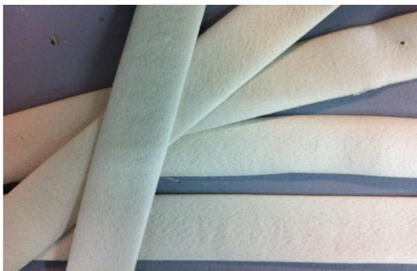
Figura 8.22. Láminas de material espumado con 1% de arcilla respecto a almidón.
