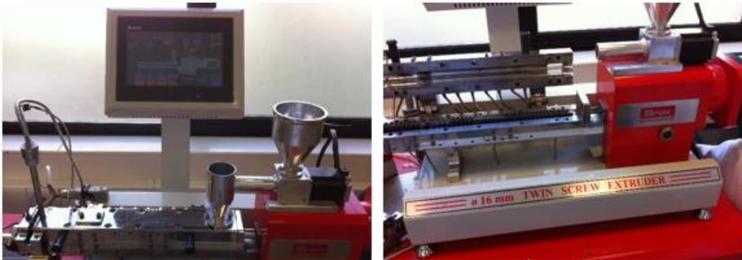
Figura 6.1. Extrusora de tornillos co-rotatorios del Departamento de polímeros de Cs. Químicas, UdeC. A la izquierda, pantalla de control. A la derecha: Extrusora.
