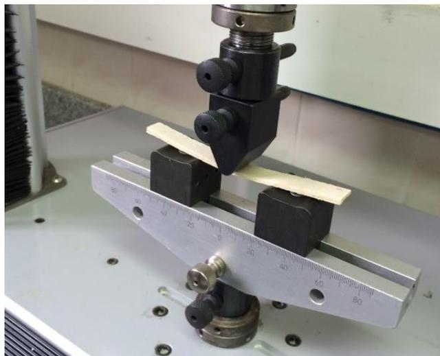
Figura 7.4. Máquina de ensayos de flexión (gentileza UDT)
