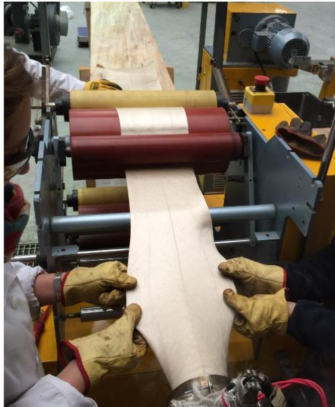
Figura 8.27. Vista de la salida del material: Cambio de forma cilíndrica a plana.
