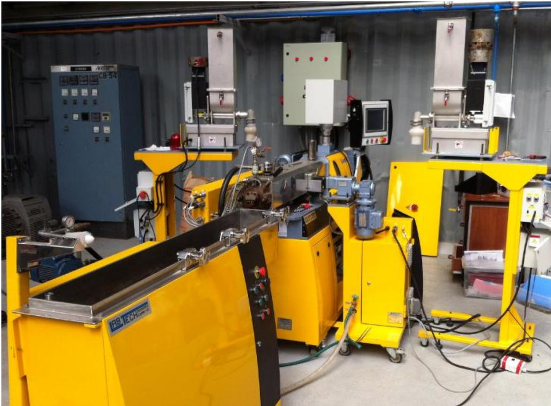
Figura 6.3. Vista general de extrusora Labtech ubicada en CIPA.
