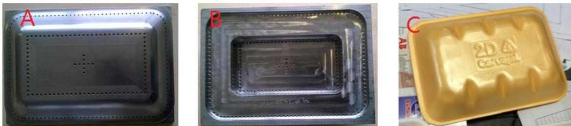
Figura 7.6. Molde metálico A) Vista superior; B) Vista Inferior y C) bandeja modelo de Carvajal Empaques, tamaño 2D.
