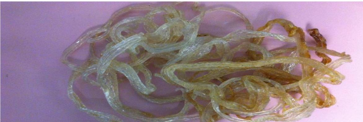
Figura 8.17. Producto obtenido en pruebas iniciales con extrusora Labtech con almidón previamente plastificado con glicerol en relación (70/30).
