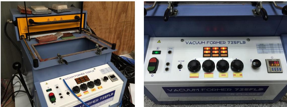
Figura 6.14. Termoformadora Vacuum Former 725FLB para el formado de prototipo de bandeja a escala real.
