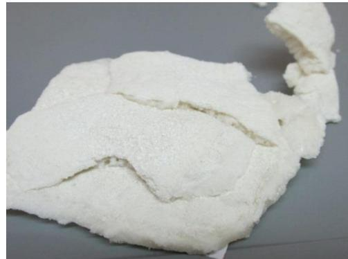
Figura 8.12. A) Nanocomposito obtenido con 20 % glicerol, 5% anhídrido maleico, 0% PVA, 72 % almidón. B) Nanocomposito con 5 %de anhídrido maleico, 3% de PVA, 69 % de almidón.
