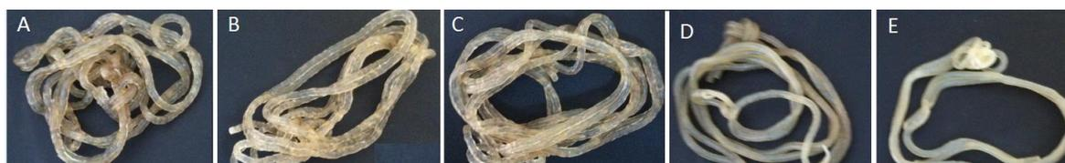
Figura 8.15. Producto extruido en extrusora Gulnar, con perfil de temperaturas 70/120/120/120 °C. a), b), c) Almidón 70%, glicerol 30%; d), e) almidón 66%, glicerol 31%, arcilla 3%.
