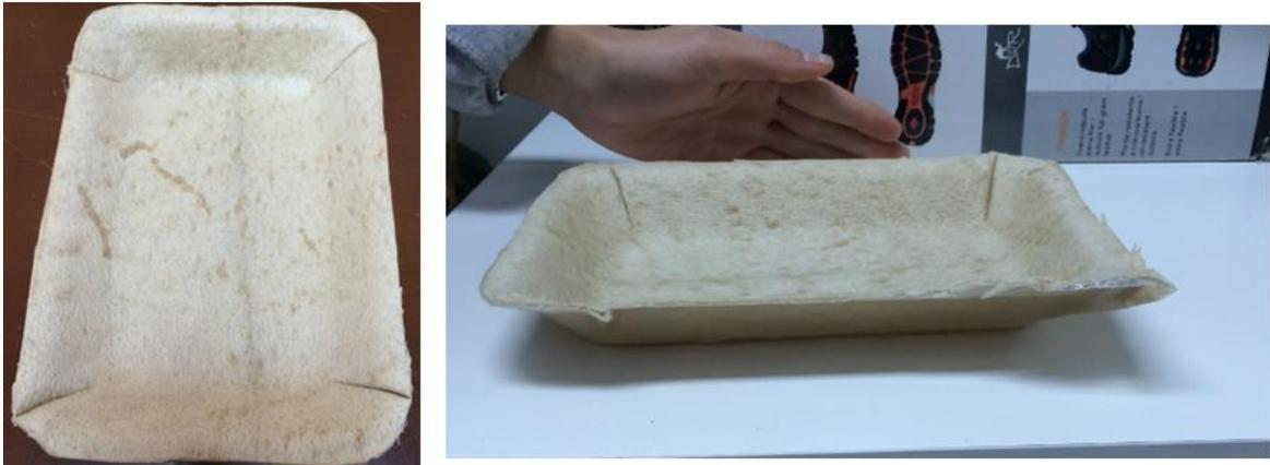
Figura 8.33. Prototipo de bandeja de material espumado biodegradable en base a almidón.
