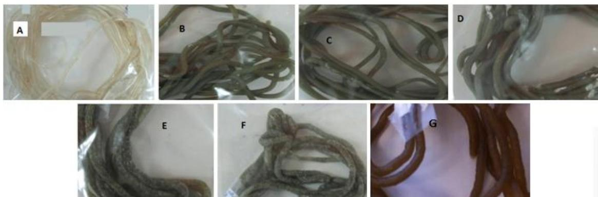
Figura 8.14. Producto extruido obtenido previamente en extrusora Gulnar: a) Almidón y Glicerol, b),c) d), e) f): Almidón, Glicerol, Anhídrido Maleico; g) Almidón, Glicerol, Anhídrido Maleico, Polvo de lija. Las temperaturas utilizadas en el rango 70/150 °C.
