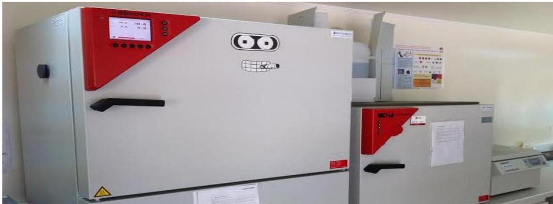
Figura 6.13. Estufas de alta precisión. A la izquierda estufa para controlar humedad.
