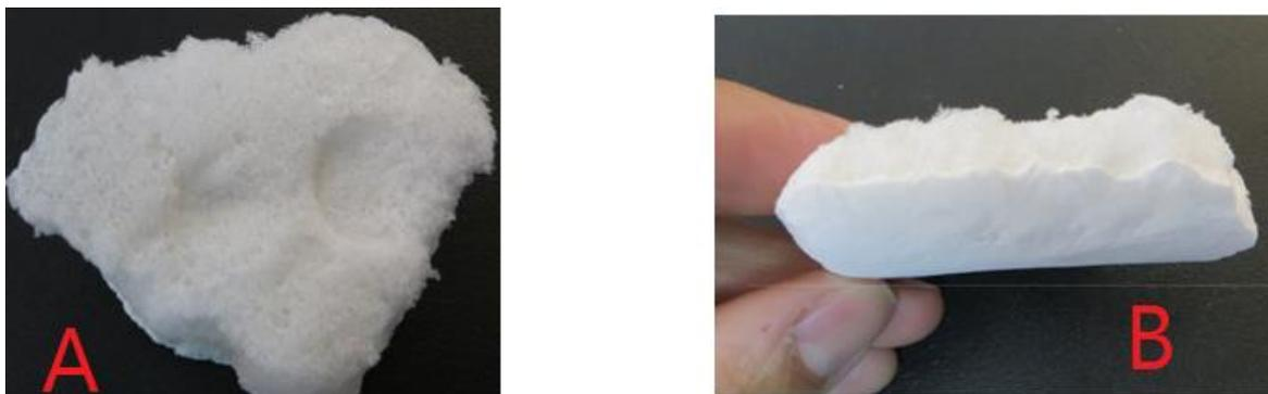
Figura 8.8. A) Espuma con alta porosidad y flexibilidad. Composición: 20% glicerol, 5% anh. Maleico y 5% PVA, 70% almidón. B) Espuma cuya composición es 20% glicerol, 5% anhídrido maleico; 3 % PVA, 72% almidón
