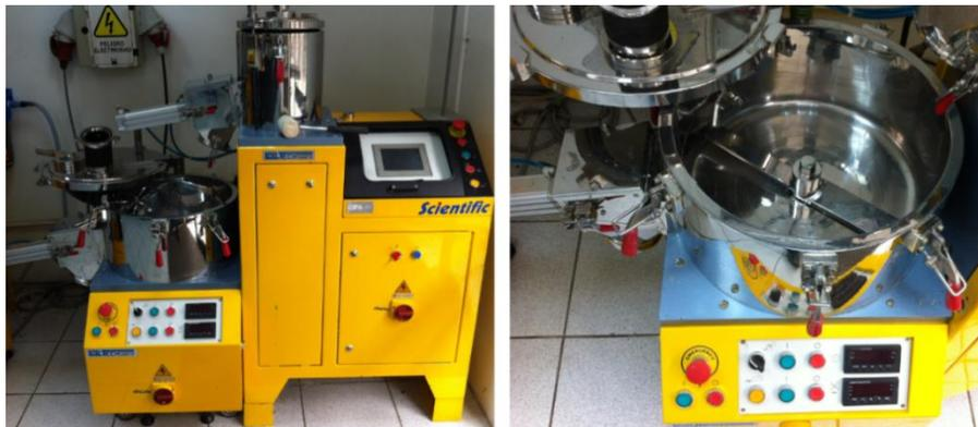
Figura 6.12. Vista del mezclador Labtech utilizado para plastificar almidón antes de extrusión.
