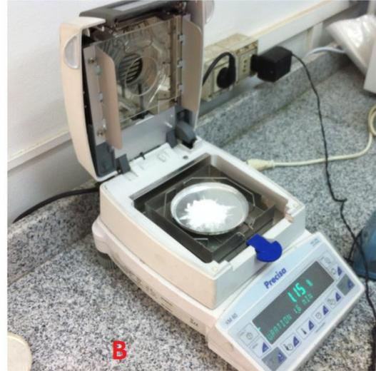
Figura 7.1. Termobalanza "Precisa XM60", utilizada para estimar la humedad de almidón.
