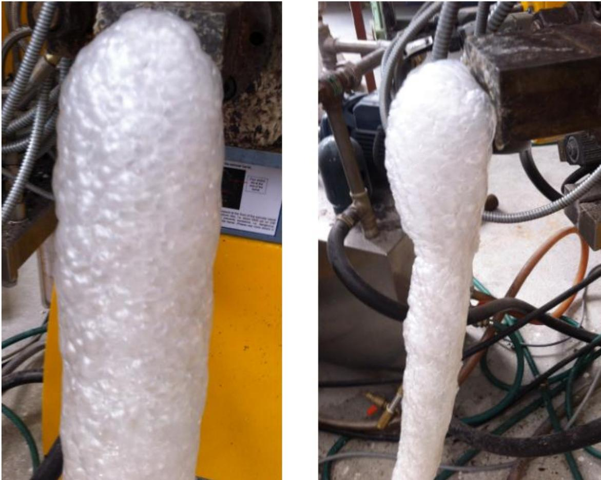
Figura 8.19. Muestra del material espumado obtenido mediante extrusión. Almidón y glicerol (ensayos iniciales).
