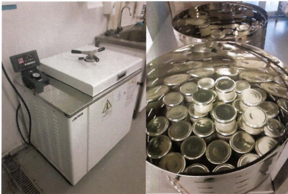
Figura 1.3 Esterilización en autoclave. Izquierda: Autoclave CREAS; Derecha: Productos en canastos de autoclave listos para esterilización.
