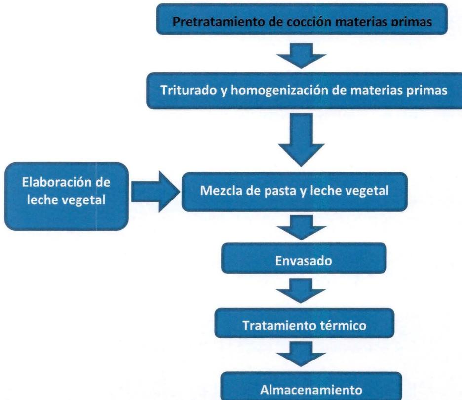
Figura 1: Diagrama de bloques del proceso
