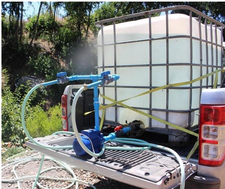
**Figura 11.** Sistema de riego para aplicación contra pendiente con motor de empuje.
