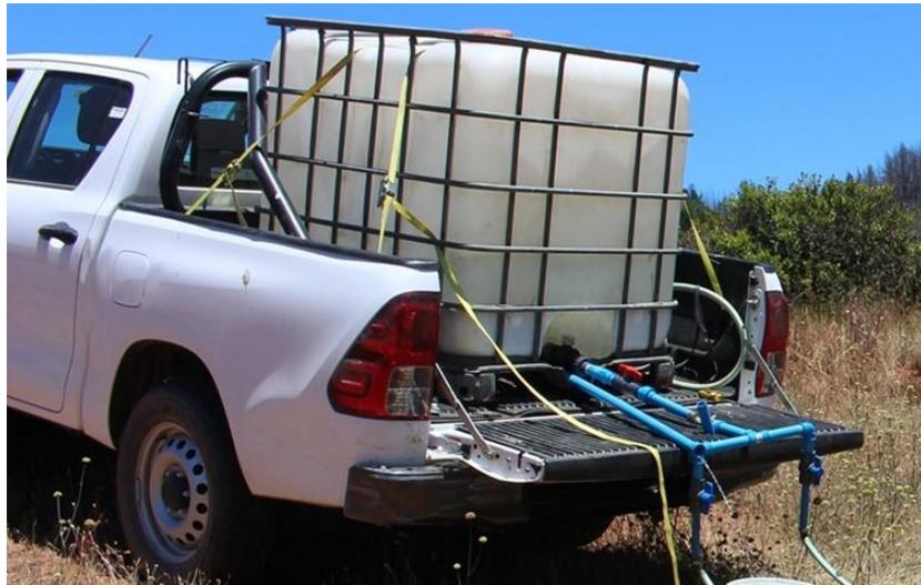
**Figura 10.** Sistema de riego por gravedad.
