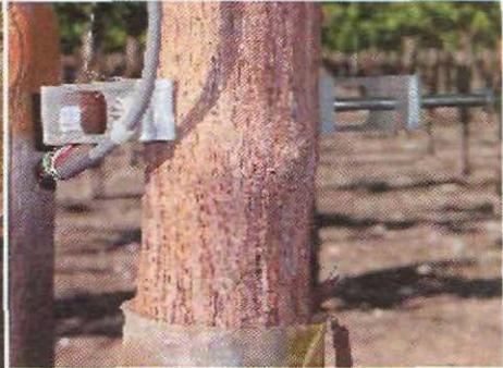
Dendrómetro o captor de desplazamiento lineal.
