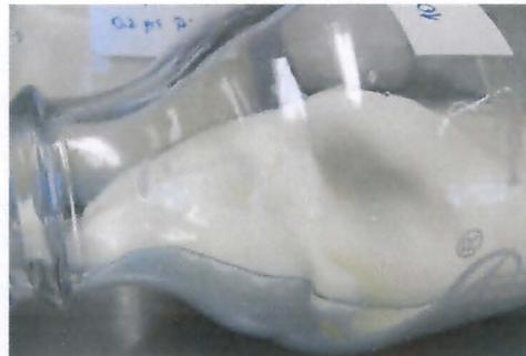
Cuajo sintético al 100% (Se observa coagulación y cambio de consistencia).
