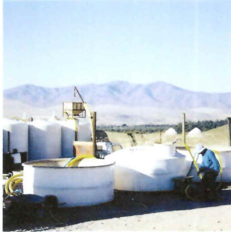
Foto 31. Traspaso de aceitunas a contenedores de fermentación mediante grúa camión
