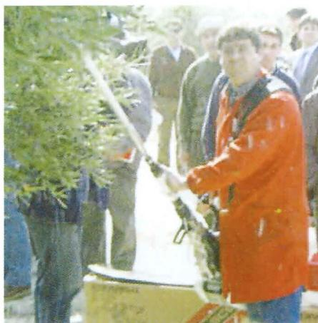
Foto 12. Vibrador manual con motor de explosión (España)
