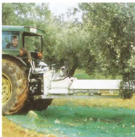
Foto 11. Vibrador unidireccional de troncos (España)
