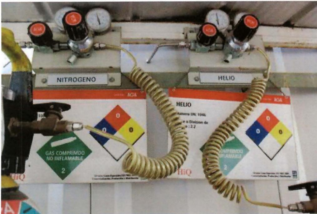
Nitrógeno y Helio, conexión directa al cromatógrafo de gases.
