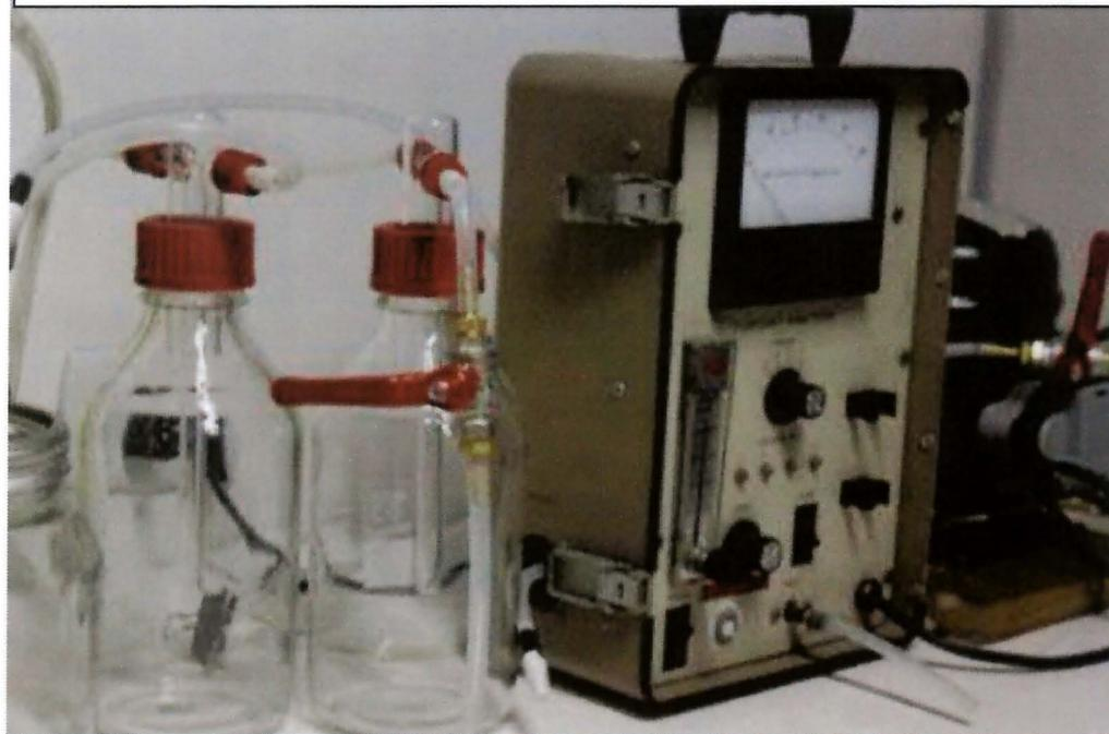
Fumiscopio de 1 m<sup>3</sup> por hora, para flujo interno de la fumigación con Formiato de etilo.
