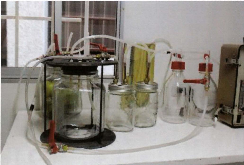
Circuito de fumigación utilizada para los ensayos con Formiato de etilo. (Vapormate)
