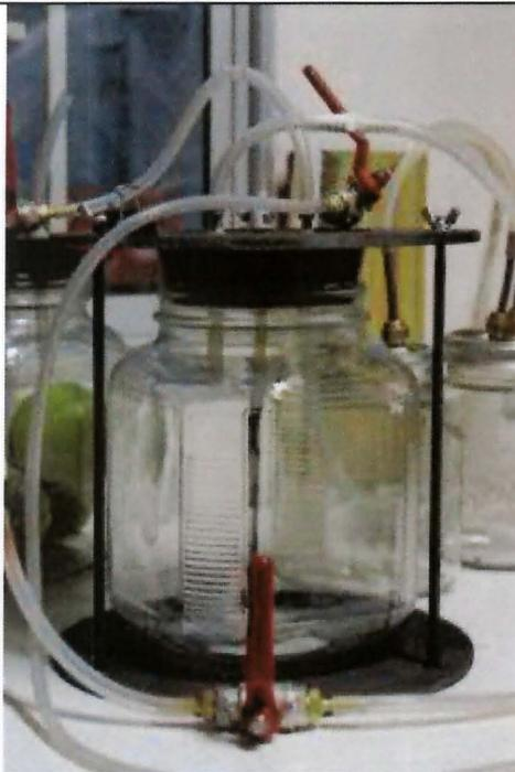
Contenedor hermético para fumigación, con válvulas de bola, tapón a medida, y armazón de contención; Rotámetro de 1L/min.
