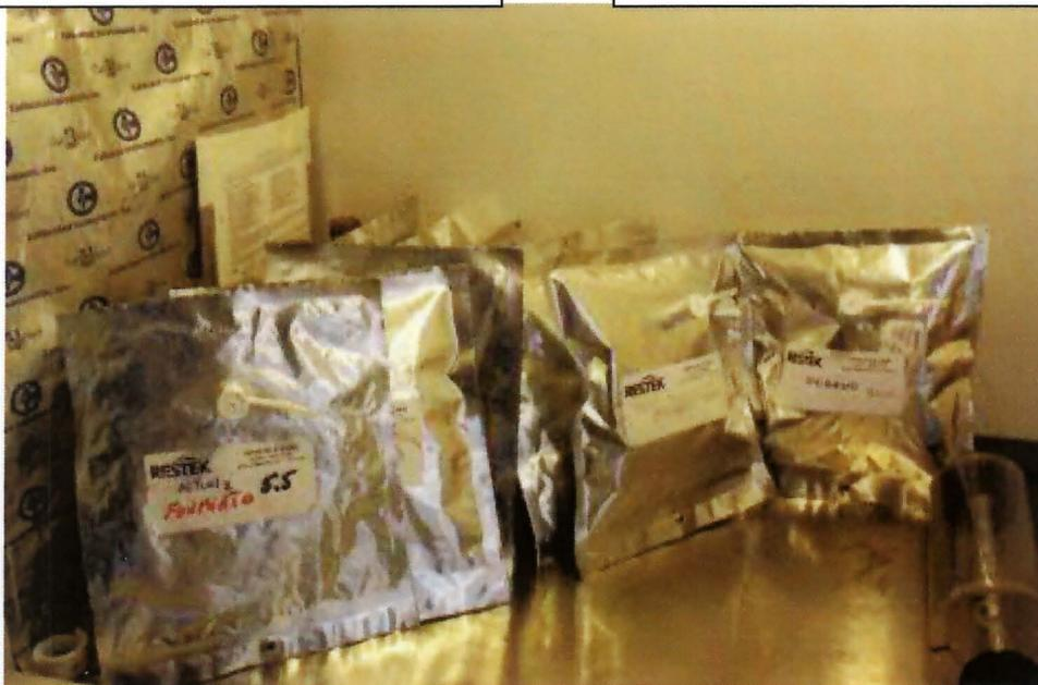
Bolsas cromatográficas utilizadas para las mezclas de gases y calibración cromatográfica.
