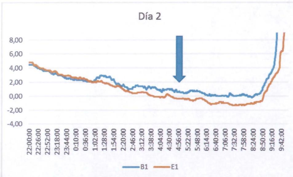
Los sensores B1 y E1 son los que se encuentran más alejados de las hélices, a 220 metros. Acá si se ve una diferencia entre el ensayo con calefactores y el que no contaba con ellos. El día 2, cuando la helada fue menos intensa, se aprecia como en B1 las temperaturas siempre son muy cercanas a 0°C y positivas. En comparación a E1 donde se ve como estas bajan de -1°C.
