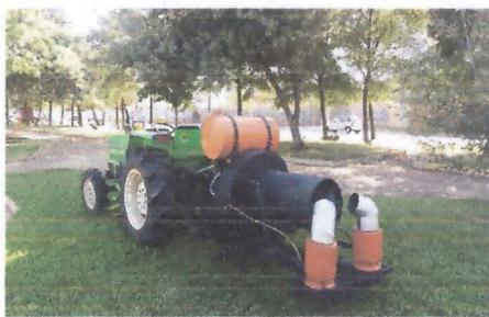
Transforma la flama en aire caliente con una salida de hasta 100° regulable. La turbina que impulsa el aire caliente tiene un alcance de hasta 70 metros
