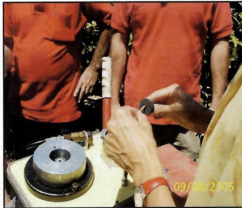
Fotografía 7. Mecanismo para medir tensión de las hojas.
