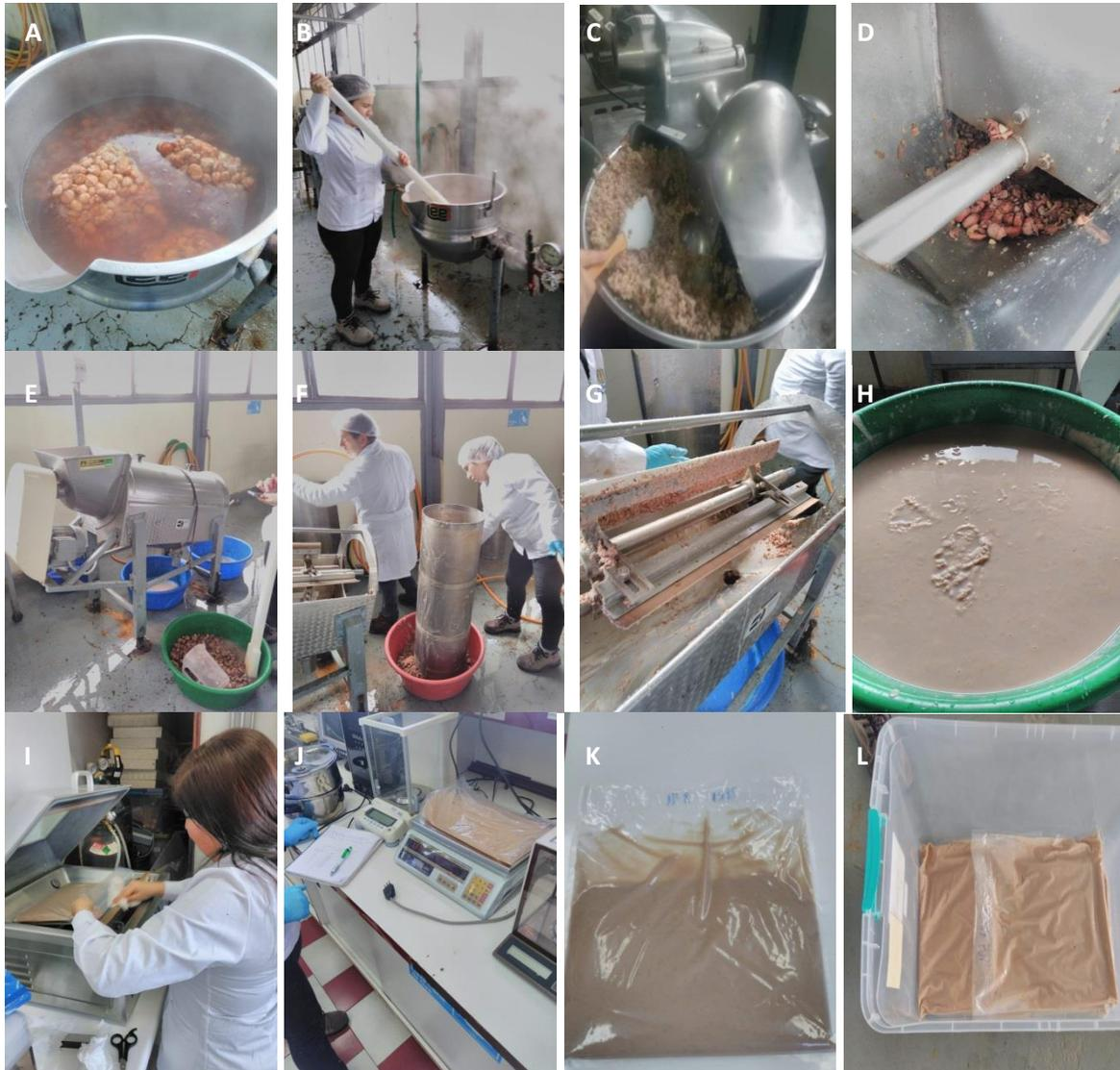
**Figura 1.** Preparación mezcla base de castañas. A y B) Cocción en marmita C) Reducción de tamaño en cutter. D, E, F,G) Pulpador con apertura tamiz 0.2. H) Mezcla base castaña/ agua (1:1), I,J,K,L) Envasado de la mezcla base, masa, identificación, vacío y almacenamiento en congelación.
