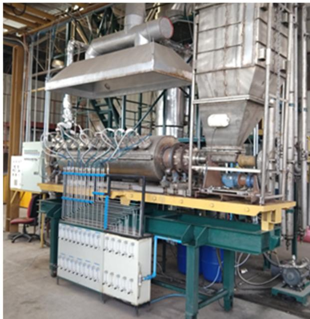
Figura 2: Planta piloto de pirólisis UDT
