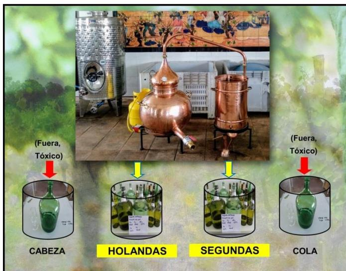
1. Es importante realizar una limpieza antes y después de utilizar el equipo solo con agua, para hacer arrastre de impurezas que se puedan acumular en ductos internos del alambique de cobre.
