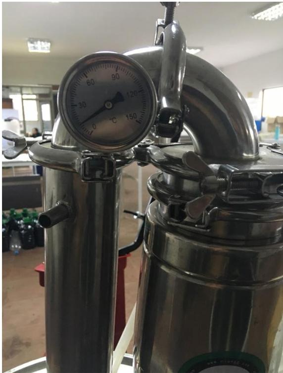
Fig. 4. Ubicación de termómetro de análisis de temperatura.
