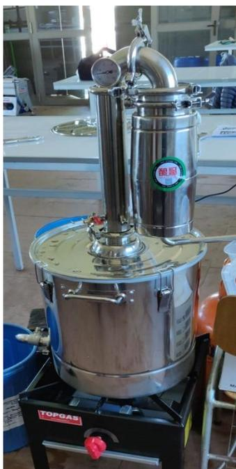
Figura 2. Destilador utilizado durante el proceso.
