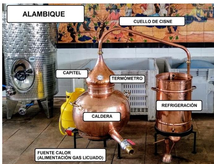
1. Fuente calor: En este caso consta de dos quemadores regulables en intensidad para entrega de calor constante sin variación, para tener certeza en la extracción de las distintas fracciones de alcoholes las cuales tienen distintos puntos de ebullición.
