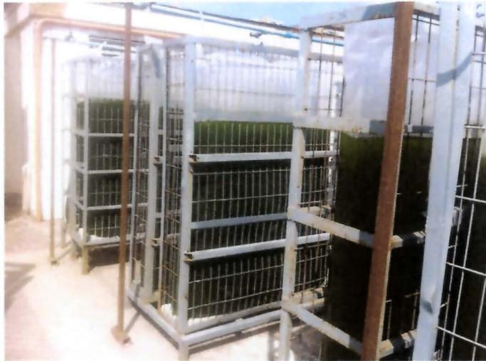
**Figura 3.** Fotobiorreactores cerrados 0,4 m<sup>3</sup> de capacidad en condiciones outdoor
