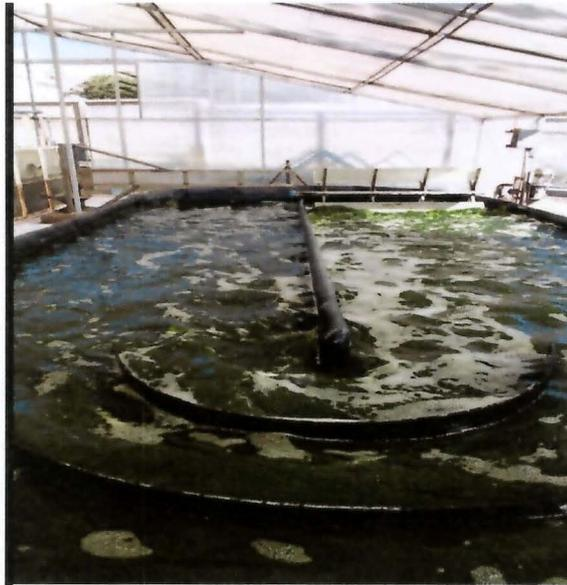
Figura 5. Sistema de cultivo abierto tipo raceway – 7,7 m<sup>3</sup> de capacidad.
