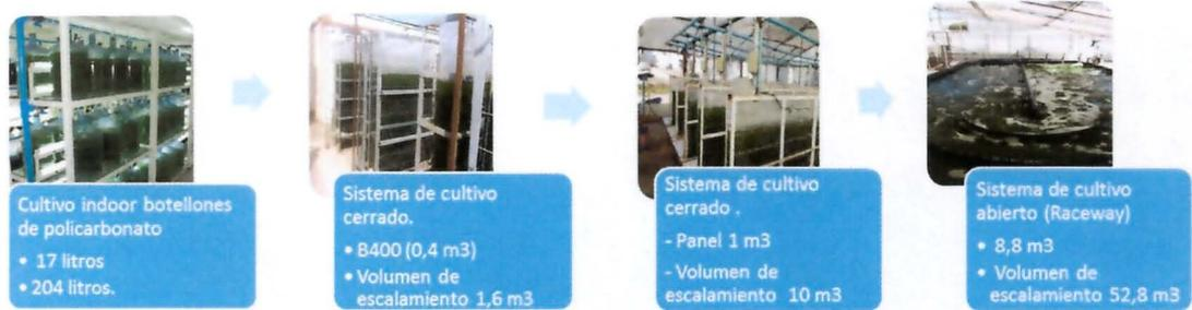
**Figura 9.** Escalamiento del cultivo de A1 a nivel piloto de 7,7 m<sup>3</sup> de capacidad de cultivo.
