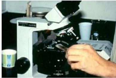
**Precaución!!** No usar alto poder i.e. x 20 / x 40 / x HI 100 aceite debido a que el objetivo puede romper el plato superior de la cámara de McMaster.
