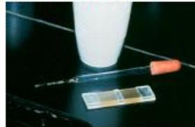
7. Dejar reposar la cámara de conteo por 5 minutos. Es importante dejar reposar la cámara para permitir que los huevos floten hacia la superficie y que los detritos se vayan al fondo de la cámara.
