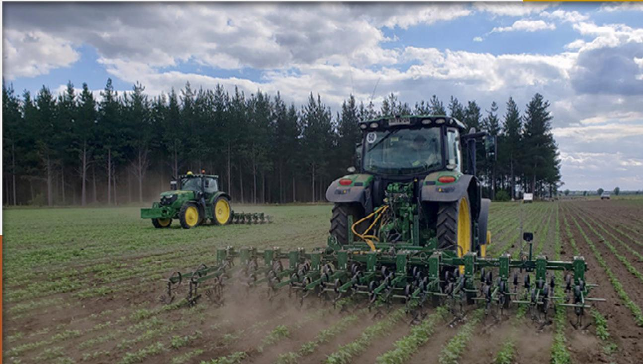
La profundidad de trabajo recomendada es de 1 a 2 cm, a una velocidad de avance de 4,8 km/h a 10 km/h). El inconveniente es que su eficacia depende de que el suelo esté bien preparado, sin terrones en superficie y con una humedad friable. Si no es así, disminuye su eficiencia.
