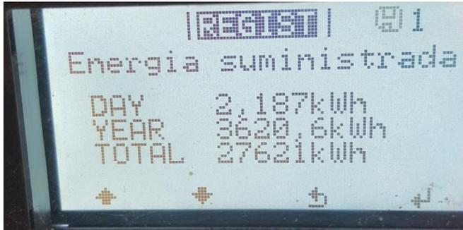
Pantalla del Inversor muestra la energía producida desde la puesta en Marcha desde Septiembre del 2015 que haciende a 27.621 kWh, la energía producida hasta el momento el año 2017 es de 3.620 kWh.
