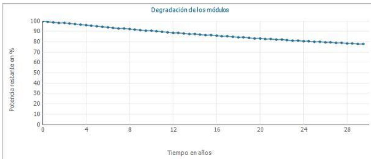
Figura: Degradación de los módulos de Superficie fotovoltaica 1
