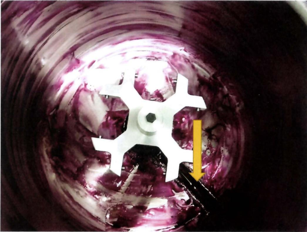
Figura 4.6: Cúpula del equipo después de la extracción del crioconcentrado (la flecha indica el surco de drenaje del crioconcentrado)
