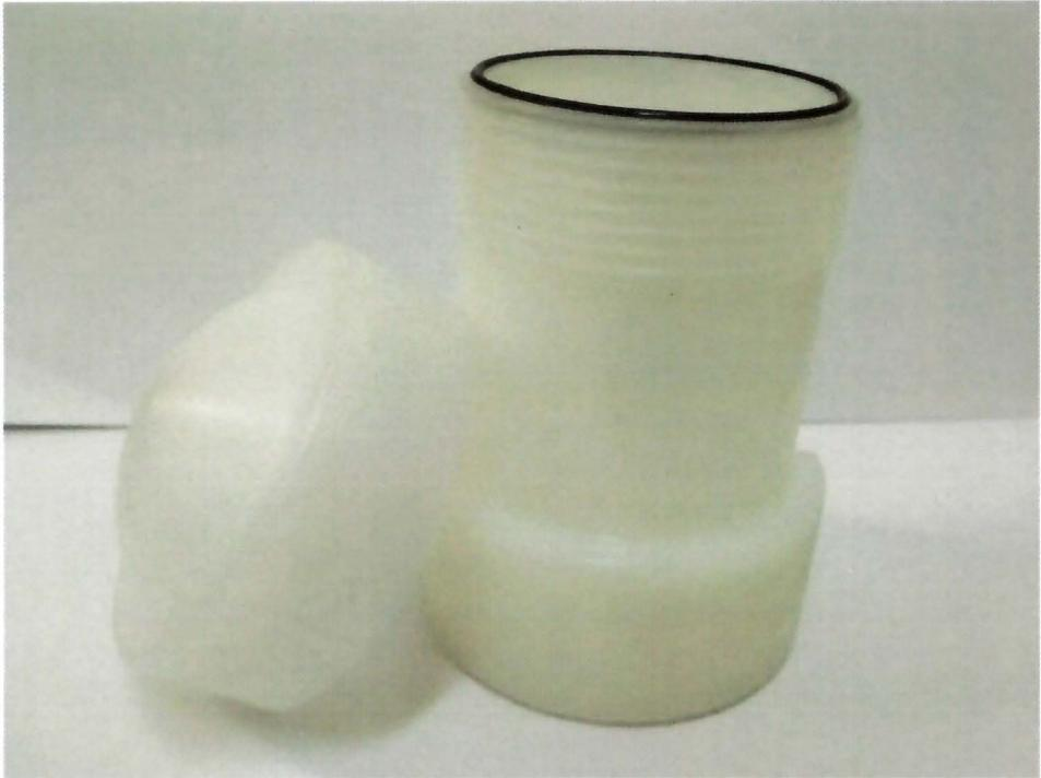
**Figura 4.4:** Tubo Crioconcentrador de 100 ml de capacidad abierto
