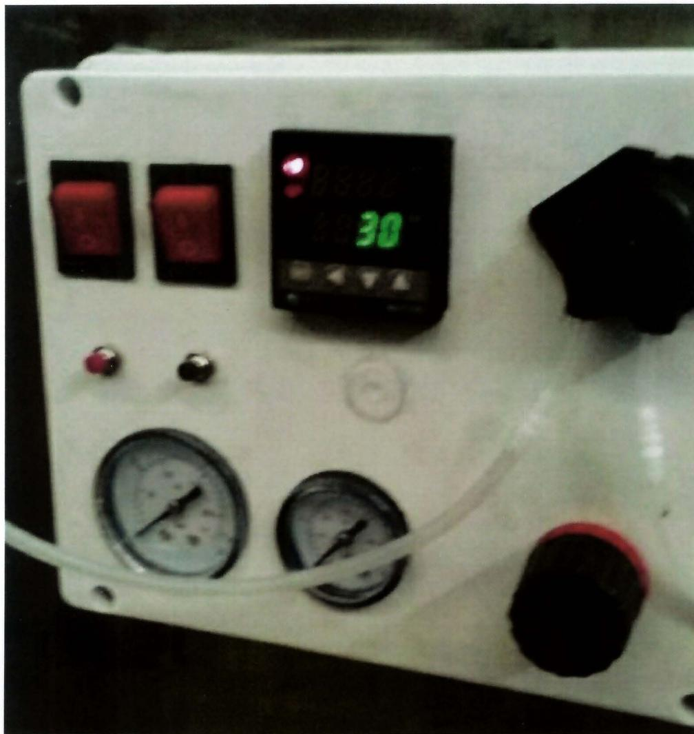
**Figura 4.11:** Comando de control de equipo Prototipo Secador por Aspersión (microencapsulador)
