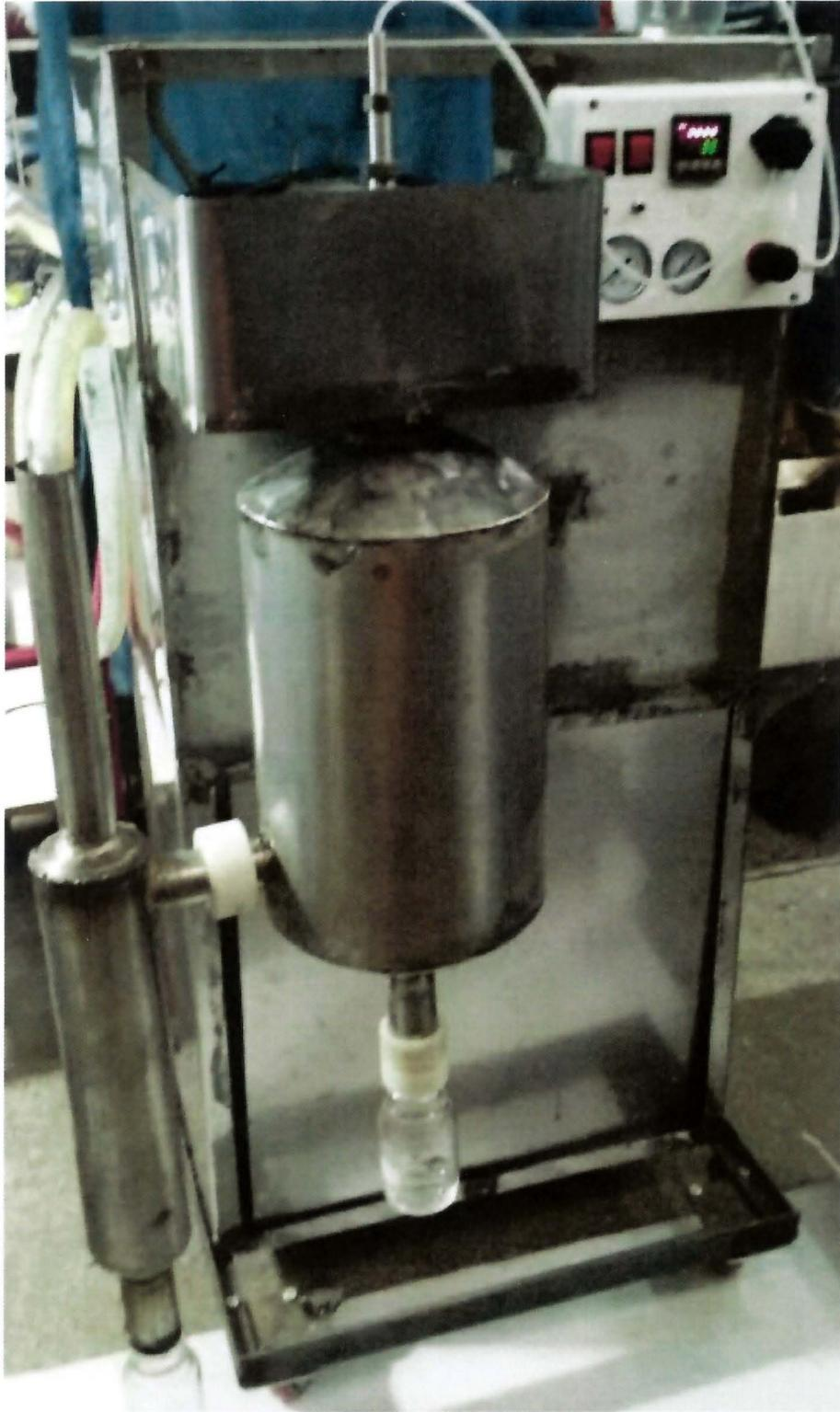
**Figura 34.10:** Vista general del equipo Prototipo Secador por Aspersión (microencapsulador)
