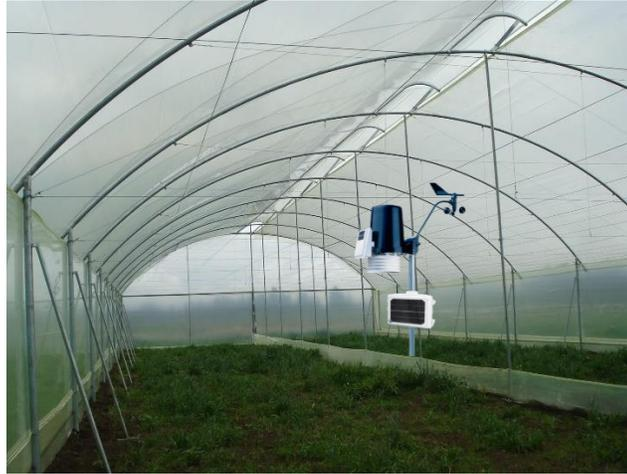
Figura 4. Sensor climático dentro de invernadero.
