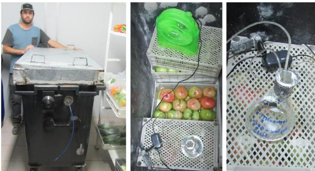
Figura 9. Contenedor modificado y aplicación de 1-MCP en Rosado de Peumo en QC.
