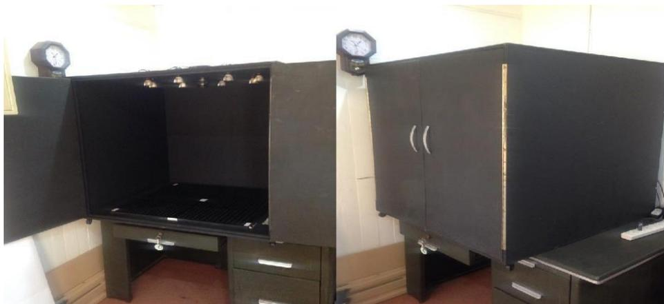
*Figura 35. Caja para captura de imágenes con cámara NIR, en condiciones de luz controlada.*
