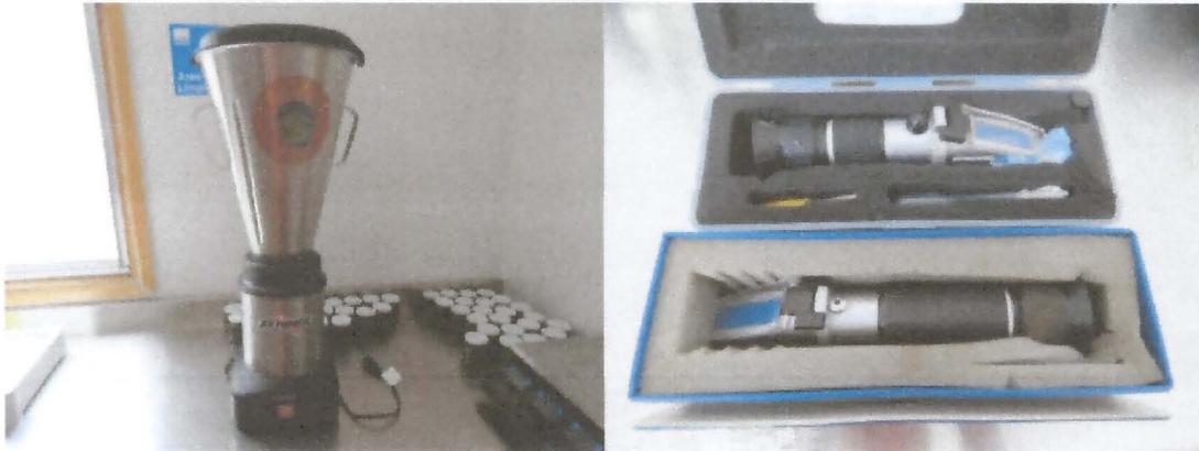
Procesador de alimentos industrial capacidad 8 l y Refractómetro.
