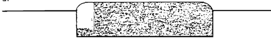
2. Después de humedecer el suelo, se empieza a aflojarlo con la barra en U, a lo largo de la cama. No se requiere usar la tabla. La profundidad de la porción aflojada por los dientes de la barra es el 75% de la que se obtiene con la doble excavación.
