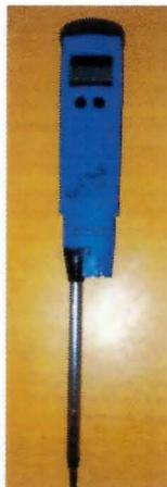
**Figura 3** Medidor de conductividad eléctrica de suelo (mS/cm)
