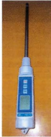
**Figura 2** Medidor de humedad del suelo (%)
